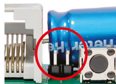
Джампер удален = энергосберегающий режим
