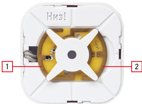
Замыкание контактов 1 и 2 для прописки датчиков
